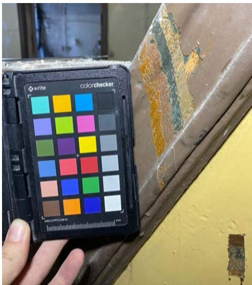
Foto 51. SONDAAZ B-TREPP-2 asub ruumis 1-14 üles viiva trep jooksu alguses. Sondeerides tuvastati kuus värvikihti, millest esimesed neli kattuvad trepi piirde käsipuu ja balustraadi alal (täpsemalt vaata sondaazikaardilt B-TREPP-2 ).
