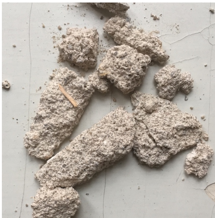
Foto 26. Foto X. N. Thamm ümberehitusega seotud krohv, peamiselt ruumis 1-7
