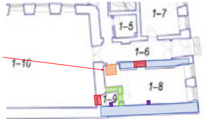
Joonis 22. Sinisega on markeeritud varasemad (1843.a. ümberehituse eelsed) seinad, lillaga maalingute umbkaudne asukoht, punasega 1843.a ümberehitusega seotud ukseavad, rohelisega 1843.a lisatud seinad, oranžiga oletatava trepi umbkaudne paiknemine.
