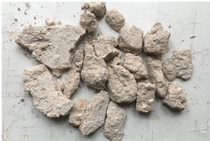
Foto 15. 1843.a krohvi näited hoone erinevatest piirkondadest – tegemist on väga selgelt eristuva krohvitööbiga, mille järgi on suhteliselt lihtne tuvastada ümberehituste mahtu ja ulatust.
